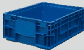
RL-KLT 4147 Внешний размер: 396x297x147,5 мм Внутренний размер: 346x265x110 мм Объем: 10,1 л Вес: 1,08 кг
