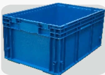
R-KLT 6280 Внешний размер: 594x396x280 мм Внутренний размер: 544x364x262 мм Объем: 51,9 л Вес: 2,67 кг
